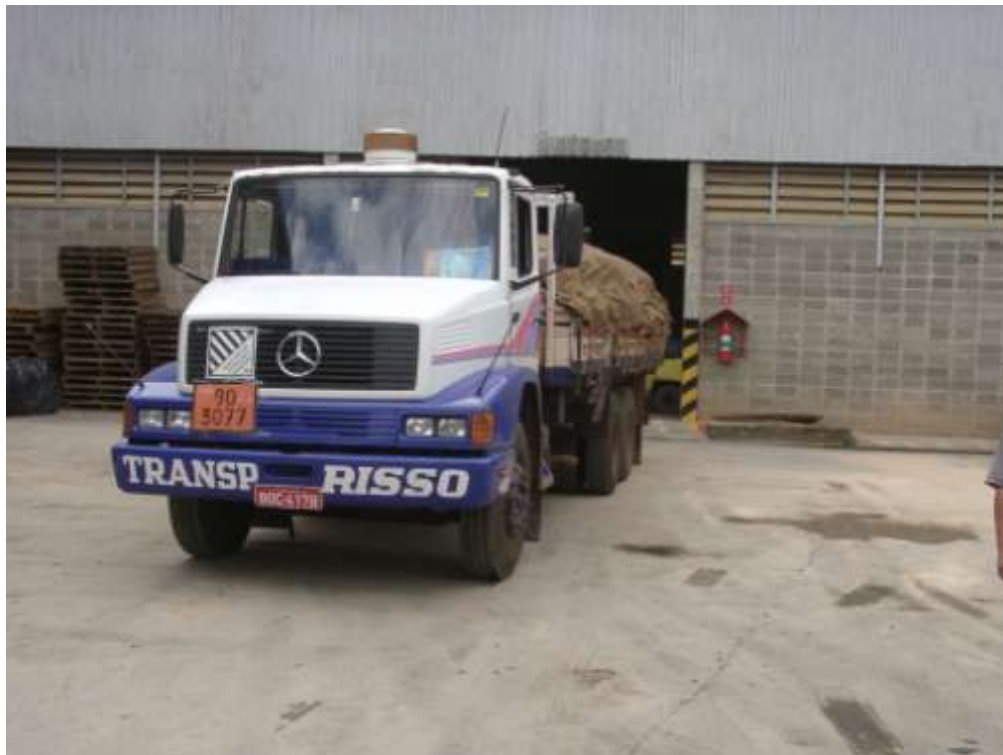
Foto 5 – Transporte pronto para seguir até o aterro para lixo perigoso em caminhão com placas indicativas de carga perigosa, que deverá estar coberta por encerado ou material resistente. As placas deverão estar inclusive na lateral da carroceria do caminhão.
