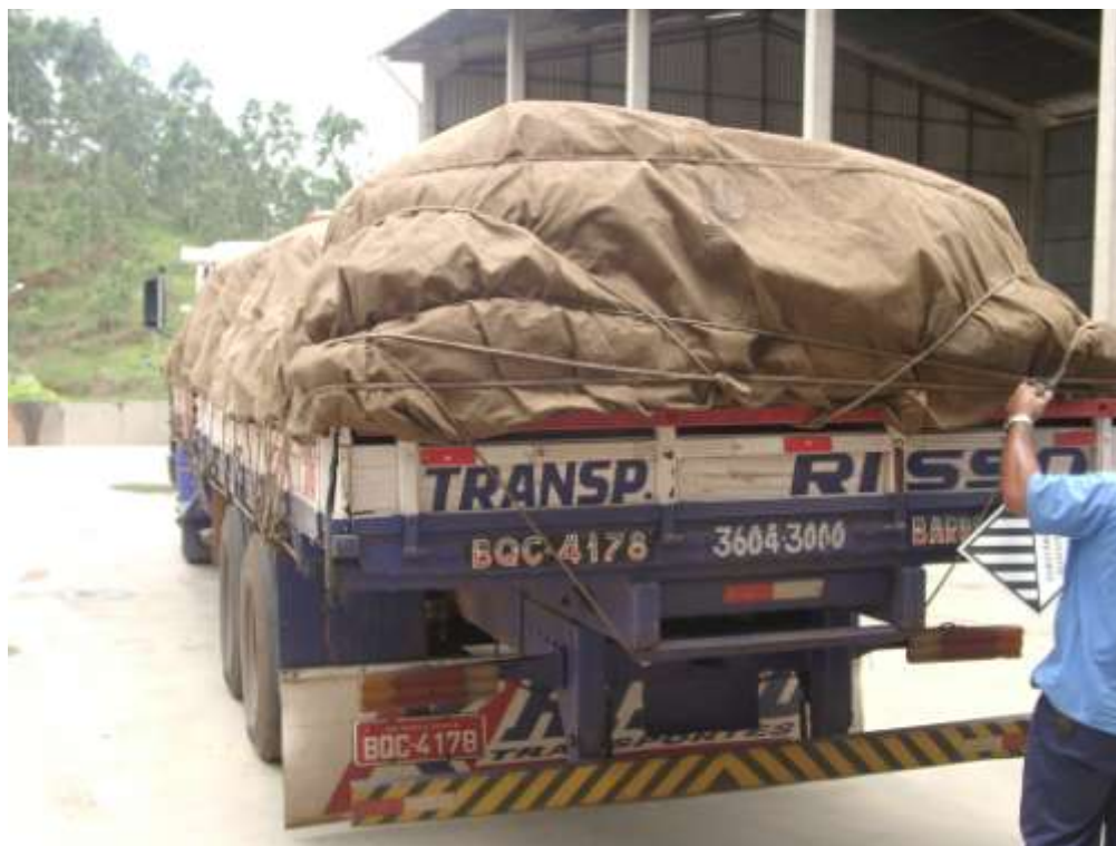
Foto 7 – Detalhe da carga de resíduos, contendo amianto, acondicionada no caminhão, para transporte até o aterro para disposição final.
