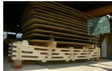
写真2 鋼板を用いた実大加力試験
