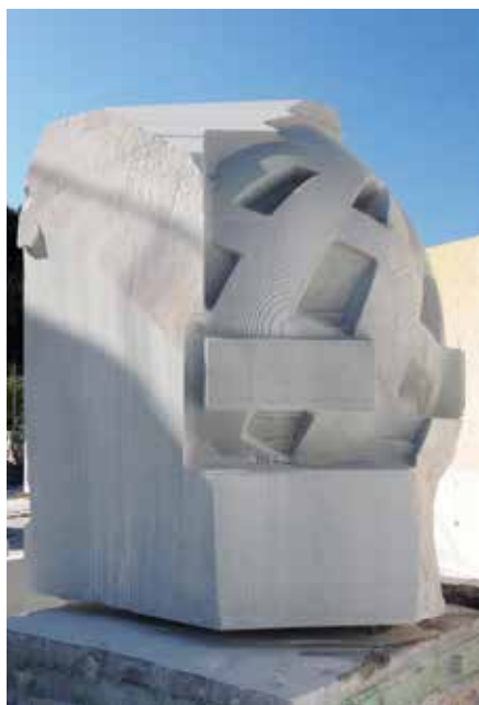
Noch im Steinbruch in Carrara wurde mit grossen Fräsmaschinen die Grundform der künftigen Skulptur aus dem Marmorblock herausgeholt.
