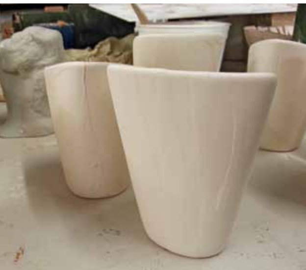
Die doppelte Tauchung ist deutlich zu sehen. Beim Glattbrand verläuft die Glasur-Überlappung jedoch weitestgehend ineinander.
