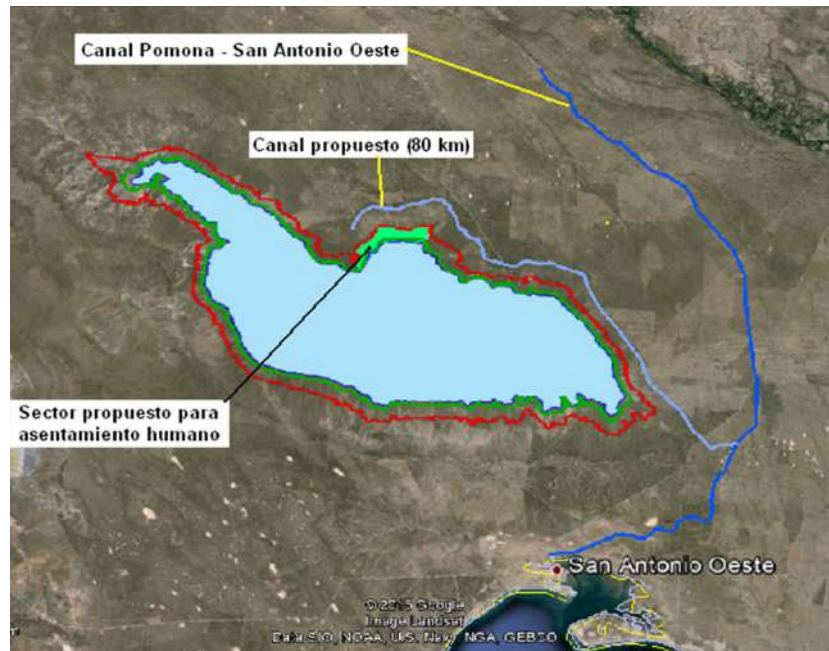
Figura 6. Propuesta de canal para abastecer agua (por gravedad) hasta el sector "muy favorable"
