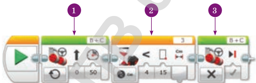
31-сурет. 15 см қашықтықта тұзу сызықпен қозғалатын роботты тоқтататын программа
