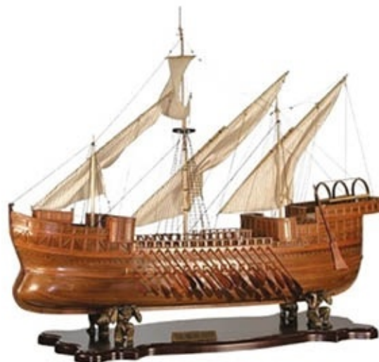
Maqueta de dromon bizantino. Tomando como base los grandes quinquerremes romanos con los que Marco Antonio luchó en Accio (31 a. C.) y las liburnas de la costa dálmata, los bizantinos desarrollaron una nave de alto bordo, de poderoso alcázar y castillos, inabordable y de
