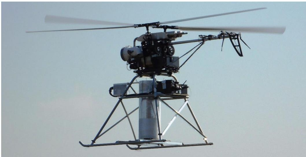
Der auf dem Flettner-Doppelrotor-System aufgebaute und motorgetriebene Dragonfly ist aufgrund seiner hohen Nutzlastkapazität von 35 kg und einer Flugdauer von über einer Stunde eine hervorragende Trägerplattform für diese bisher in bemannten Flugzeugen und Hubschraubern eingesetzte Art von Sensorik.
