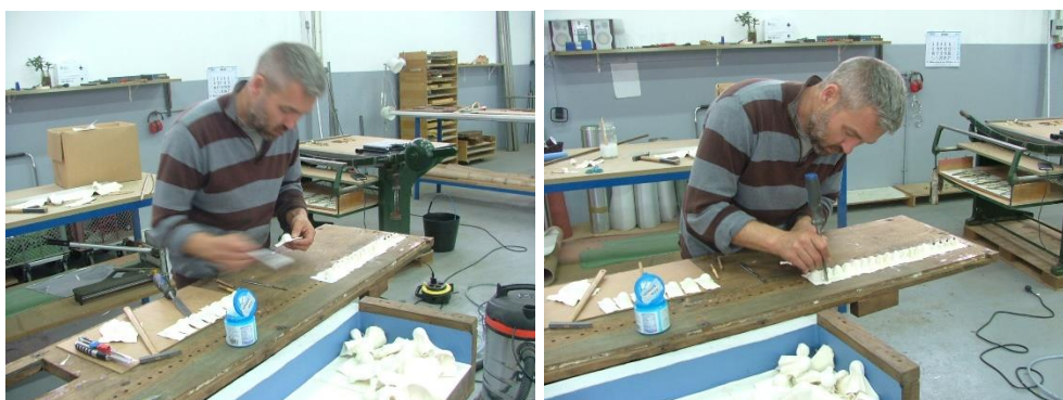
Figura 17 – Restauro do someiro; fabricação das novas tetinas da arca de ventos
