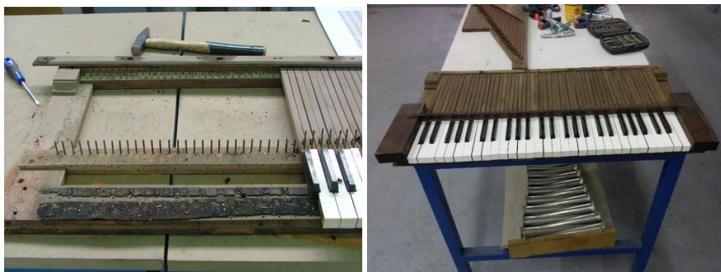
Figura 29 – Bastidor e teclado manual do instrumento antes do restauro, cujas guias originais clarificaram que as respectivas teclas foram aumentadas em comprimento e recobertas por matéria plástica numa intervenção realizada no séc. XX.
