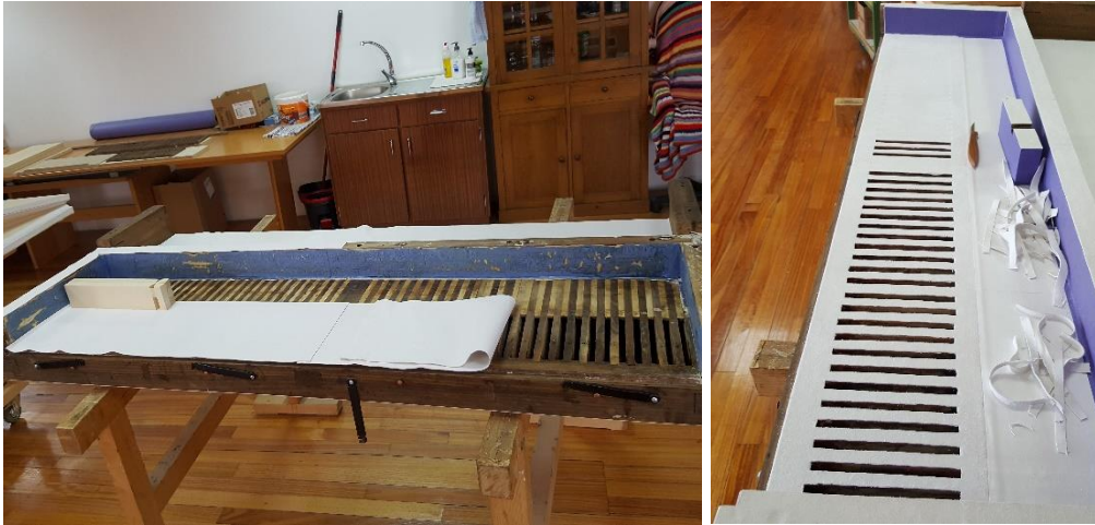
Figura 18 – Restauro do someiro, colocação de peles novas na arca de ventos e reabertura dos canais das notas.
