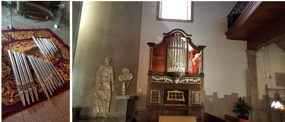
Figura 33 – Novos tubos da entonação do instrumento (Oitava real de mão esquerda) construído segundo a fatura original de António José dos Santos.
