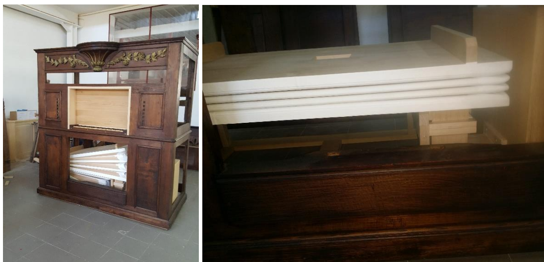
Figura 14 – Novo sistema de alimentação de ar construído no presente restauro (fole de cunha), de acordo com os traços encontrados na caixa do instrumento, congénere ao sistema de alimentação de ar existente no órgão construído
