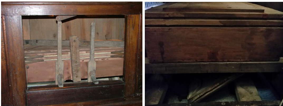
Figura 12 – Sistema de alimentação de ar que se encontrava no instrumento (fole paralelo ou de lanterna), proveniente de intervenção realizada já no século XX.
