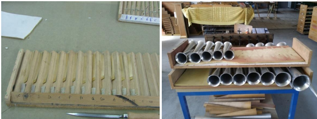
Figura 48 – Construção de linguetas e ressoadores para os tubos de palheta.
