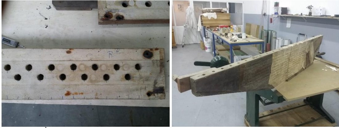
Figura 21 – À esquerda, tabuão originalmente correspondente (Rabecão) – registo de palheta de mão esquerda desaparecido no instrumento de Ribeirão e que deu lugar à composição, no presente restauro, de um Fagote, cópia fidedigna do registo existente no já mencionado órgão António José dos Santos de Paranhos, devido à inexistência de outro registo de Rabecão construído pelo organeiro conhecido –; à direita, tabuão localizado na parte posterior do someiro. No caso da inscrição “R. cao ”, único vestígio da existência deste registo originalmente no órgão de Ribeirão, a mesma encontra-se gravada na madeira do correspondente tabuão.
