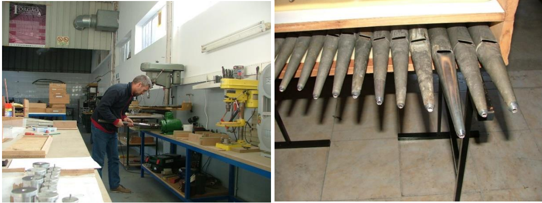
Figura 39 – Restauro dos tubos labiais de metal.
