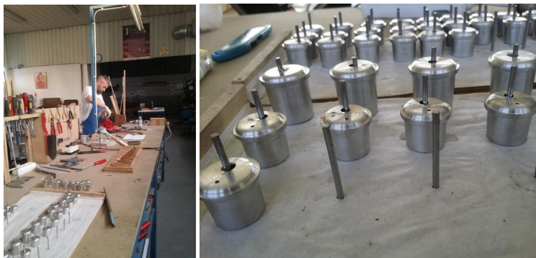
Figura 46 – Construção de novos nós para os tubos de palheta.
