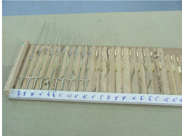
Figura 47 – Construção de novos afinadores para os tubos de palheta.
