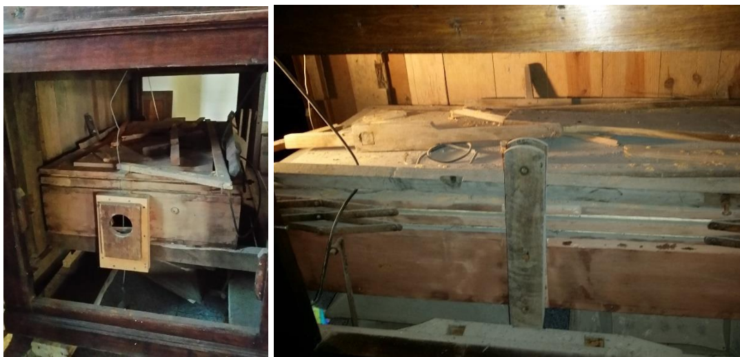
Figura 13 – Sistema de alimentação de ar que se encontrava no instrumento (fole paralelo ou de lanterna), proveniente de intervenção realizada já no século XX.
