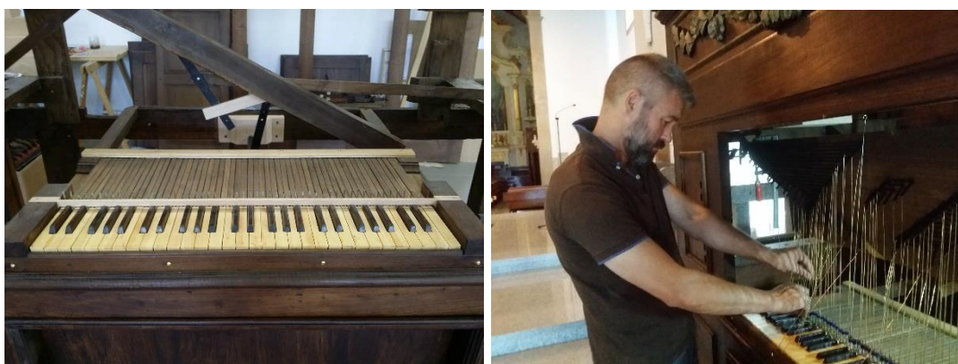
Figura 30 – À esq., novo teclado manual construído em buxo para o instrumento com base nos traços originais encontrados no respetivo bastidor e de acordo com teclados de outros instrumentos coevos e esteticamente congéneres ao órgão de Ribeirão; à dir., remontagem da mecânica de notas do instrumento devidamente restaurada, com as novas varetas em latão.
