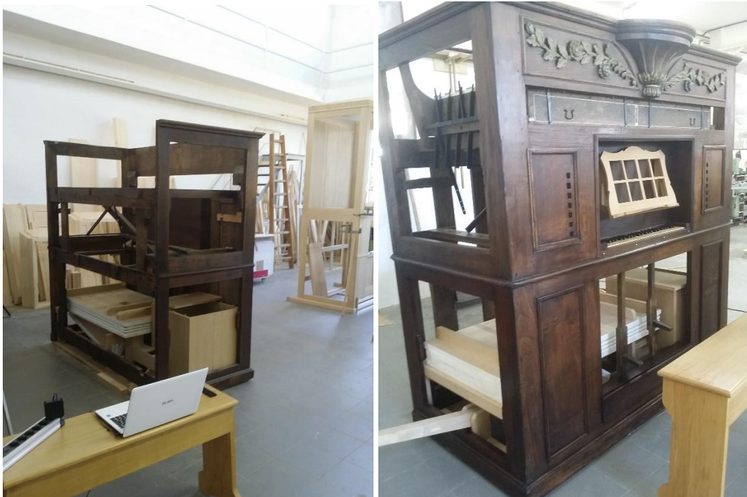
Figura 10 – Parte inferior da caixa do órgão durante o processo de restauro, onde se aprecia a incorporação de uma nova estante, banco, sistema de alimentação de ar e respetiva alavanca ao instrumento.
