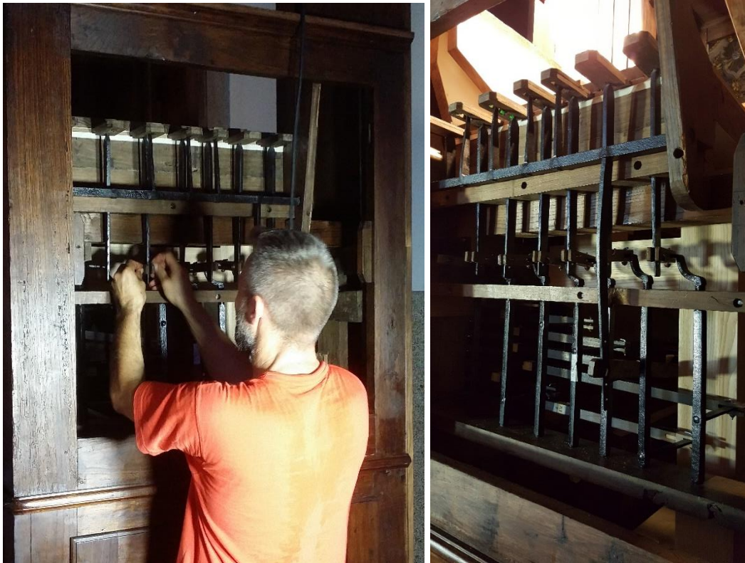
Figura 26 – Remontagem da mecânica de registros devidamente restaurada.
