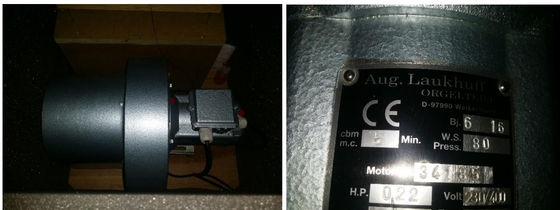
Figura 15 – Motor Laukhuff que passou a integrar o novo sistema de alimentação de ar do instrumento e respetivas especificações.
