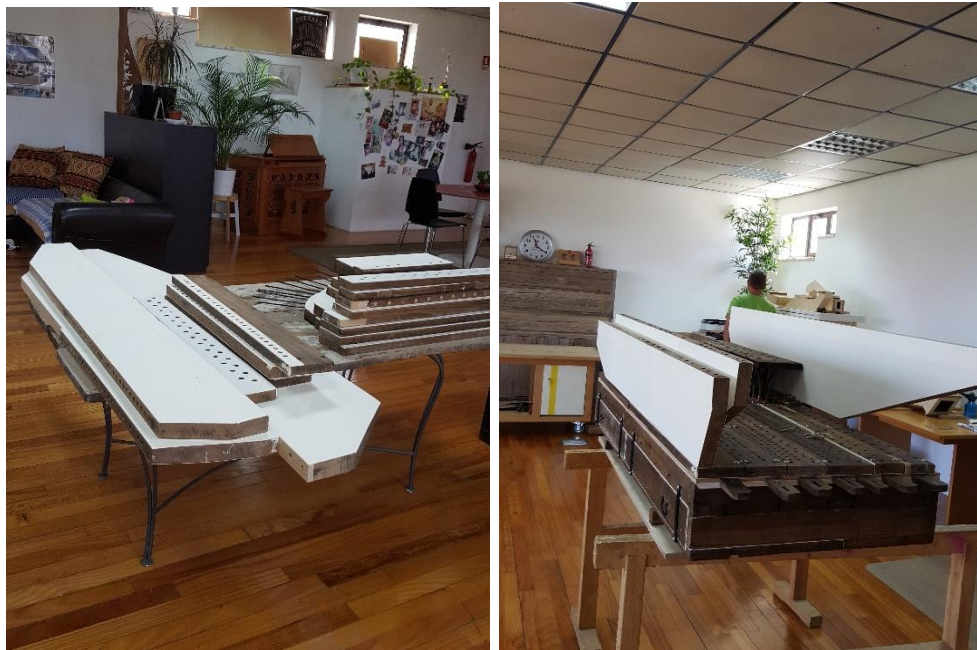
Figura 23 – À esq., tabuões do órgão de Ribeirão completamente restaurados; à dir., recolocação dos tabuões sobre o someiro do instrumento.
