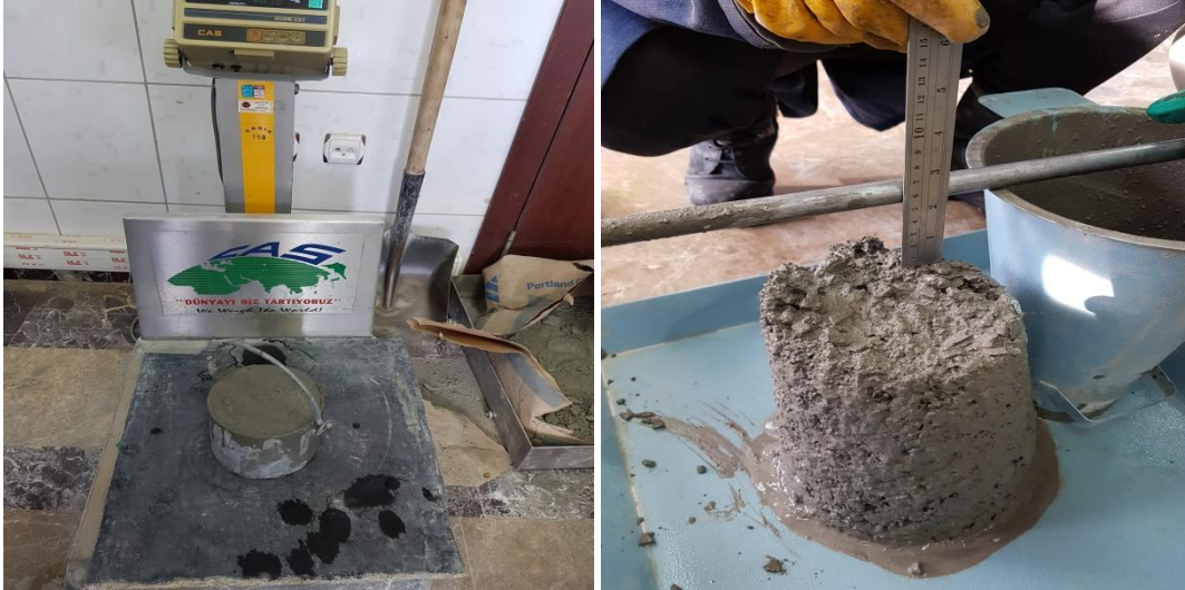
Şekil 3. Birim hacim ağırlık ve slump tayini deneyleri esnasından kesitler
