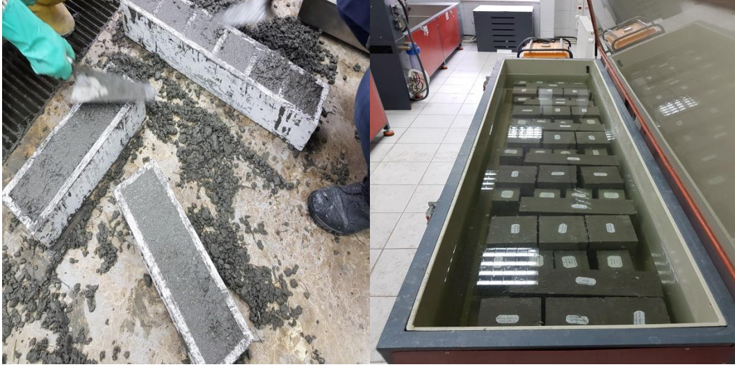
Şekil 4. Kiriş numunesi alım işlemi ve kür havuzundan kesitler
