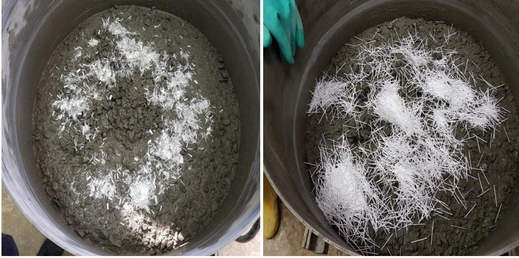
Şekil 2. Beton karışımlarına fiber donatıların ilave edilmesinden kesitler
