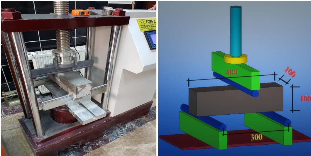
Şekil 5. Kiriş eğilme deneyleri için hidrolik pres ve deney düzeneği kesitleri
