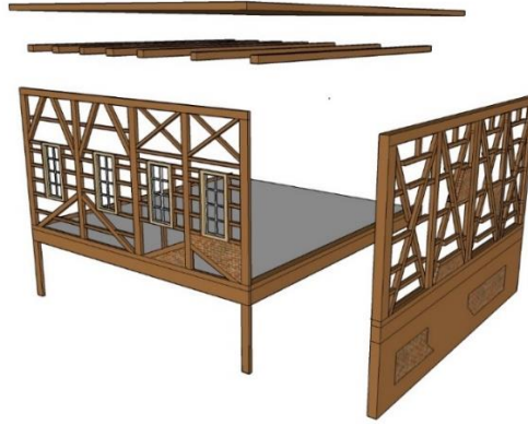
Şekil 2. Geleneksel Adana Evi'nin strüktürel katmanı(Yazar)
