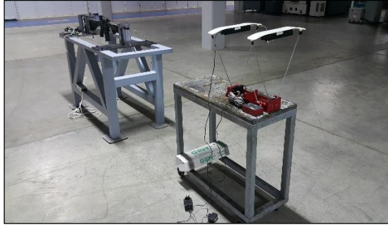
Resim 5. Kronograf(hız ölçer) ve ekipmanlarının sistem üzerinde görünümü.
