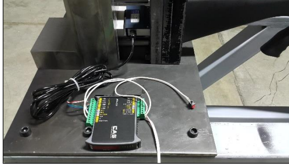
Resim 3. Load Cell ve Weight Transmitter'in sistem üzerinde görünümü.
