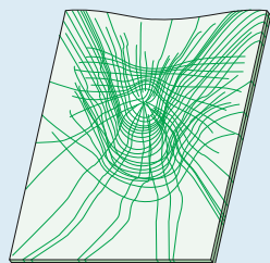
I laminert sikkerhetsglass henger glassplintene fast i plastfolien, således minimeres risikoen for kuttskader.
