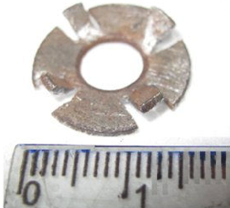
Figura 5: Mola tensionadora do eixo do rotor formada por cortes radiais e lingüetas anguladas em uma arruela.
