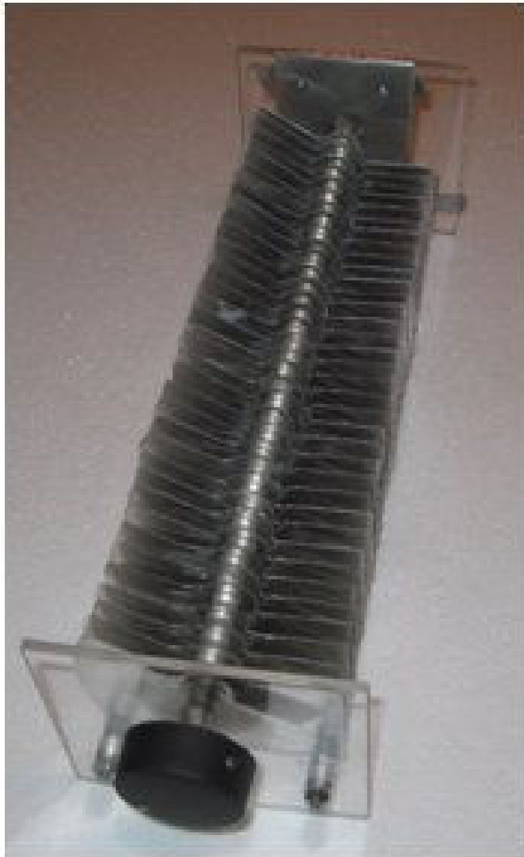
Figura 1: Foto do capacitor montado com 3 eixos e 37 placas no estator e 37 no rotor.
