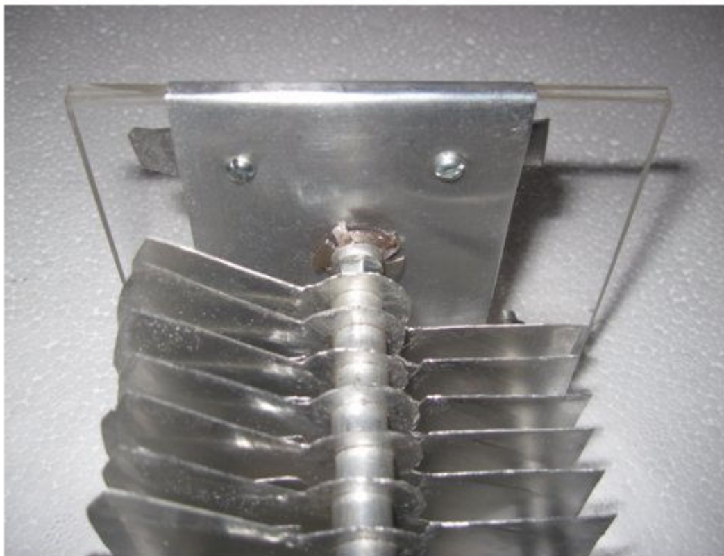
Figura 6: Posição da mola tensionadora do eixo do rotor .
