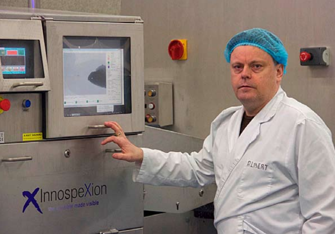
Albert Svavarsson framkvæmdastjóri Ísfiskjar við nýja tölvustýrða vatnsskurðarvél fyrir tækisins. Á skjánum má sjá röntgenmynd af flaki sem rennur í gegnum vélin.
