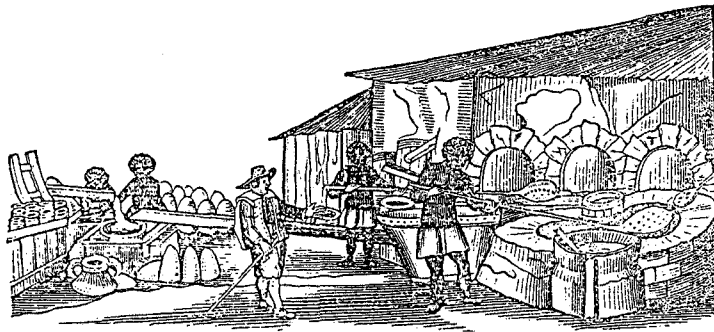
Figura 15. Processo de fabrico do açúcar: um mestre de açúcar dirige o cozimento e a remoção de escumas do caldo de cana nesta imagem do século xvii.
