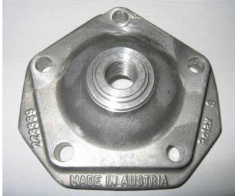
c) La altura del inserto de cámara de combustión tiene que ser 27,55 mm con una tolerancia
