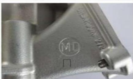
h) 125 Junior MAX y 125 MAX altura del cilindro debe ser 87 mm -0,05 / +0,1 mm (medido con un calibre digital. 200 mm de longitud).
