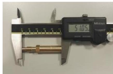
b) Largo de la sección inferior:  $33,0 \pm 0,45\text{mm}$ .
