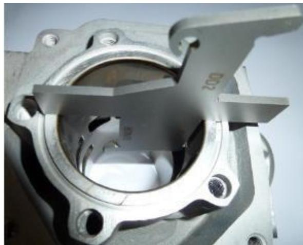
Inserte la plantilla en el cilindro, (tenga cuidado de utilizar el calibre correcto JUNIOR, MAX O DD2) y mueva la plantilla en el punto más alto del puerto de escape. En esta posición la plantilla no puede tocar la pared del cilindro.
