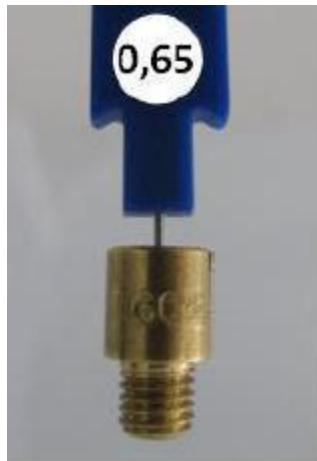
La sonda de prueba 0,65 mm no puede entrar en el agujero del surtidor de ralentí 60 (uso de calibre jet set Parte ROTAX. 281 920).
