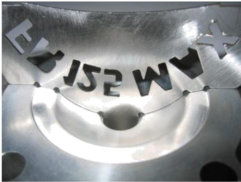
d) El perfil de la cámara de compresión tiene que ser comprobada con una plantilla (ROTAХ parte no.277 390).
