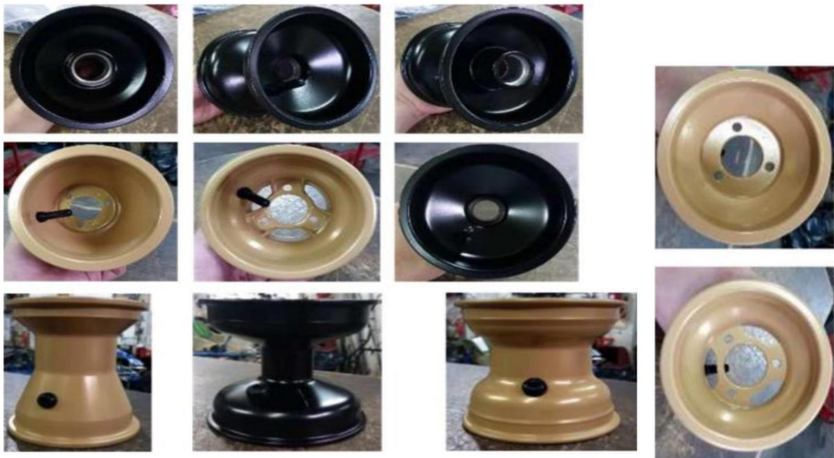
Llanta TRASERAS de 8" (pulgadas) para piso SECO, con centro de 40 y 45.
