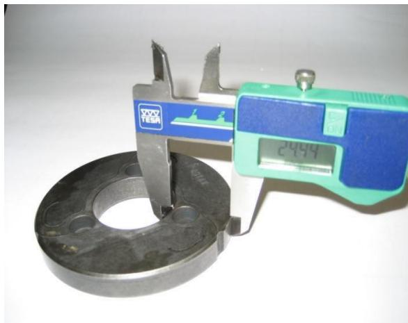
La medición se tiene que hacer en los 3 extremos abiertos de las zapatas del embrague, 5 - 10 mm de la ranura maquinada (todas las zapatas del embrague deben estar completamente cerradas en la medición - sin espacio).
