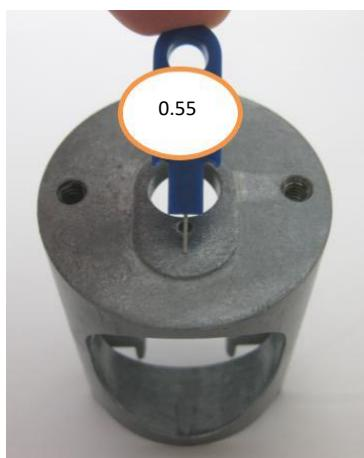
Agujero vertical: Sonda de prueba de 0,81 puede no encajar (uso calibre jet set Parte ROTAX 281 920.).
