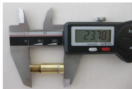
atomizador , la longitud de la parte cilíndrica :  $15,75 + / - 0,25$  mm
