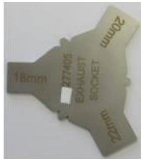
**El perfil interno de los conos de la brida de escape debe verificarse con la plantilla Rotax 277405. Montar la plantilla micro “18mm”mini “20mm”lo más posible en la brida de escape (sin junta y eliminando los depósitos de carbón) tiene que haber una luz uniforme y constante entre la plantilla y el cono de la brida**
