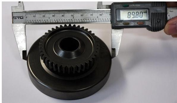
El Diámetro de la campana de embrague debe ser medido con un calibre en el extremo del lado cerrado de la campana (no en el extremo abierto de la campana de embrague).
