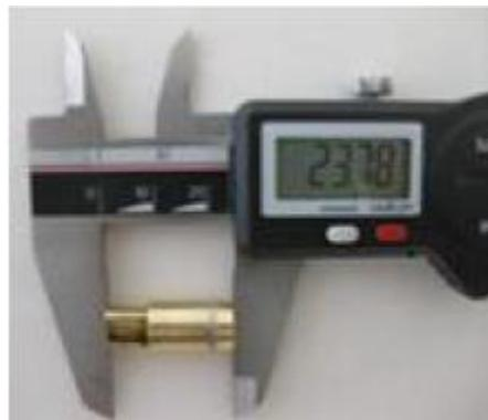
g) atomizador, la longitud de la parte cilíndrica:  $15,75 \pm 0,25\text{mm}$
