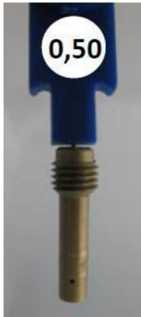
f) Retire el atomizador del cuerpo del carburador por medio del conjunto de herramienta Venturi (ROTAХ no 676034) atomizador, longitud total: 23.75 +/- 0,35mm
