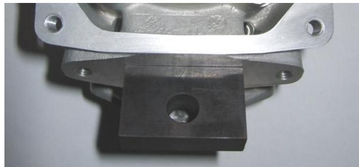
Si el pistón se mueve en la dirección superior del cilindro (PMS) y la primera vez que cubre completamente el puerto de escape, debe ser posible insertar el calibre de la válvula de escape (ROTAХ parte no. 277 030) hasta que se detenga en la superficie del cilindro (un calibre de espesores de 0,05 mm no debe ser posible de encajar en cualquier área de alrededor).
