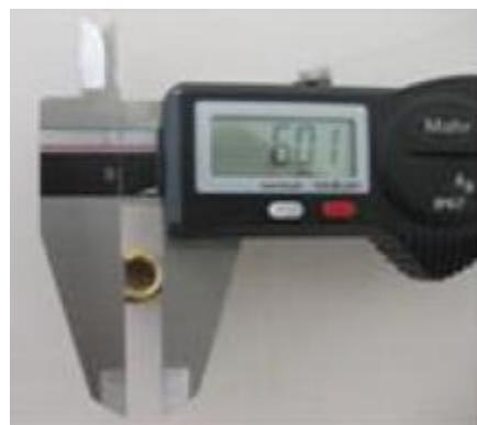
a) atomizador , diámetro de perforación transversal:  $5,0 \pm 0,15\text{mm}$
