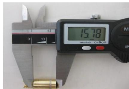
atomizador , dimensión del corte :  $6,00 + / - 0,15$  mm
