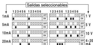
Donde se requiere una salida de voltaje, la conexión es por los terminales, 7 y 8 y para la salida de corriente, conecte a los terminales, 11 y 12.
