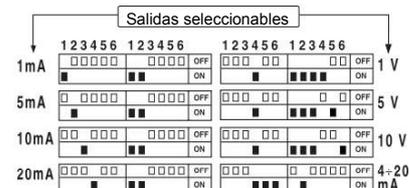
Cuando se requiere una salida de voltaje, la conexión es por los terminales 13 y 14 para la salida de voltaje, para la salida de corriente, conectar a los terminales 17 y 18.
