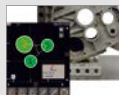
Mesure en mode 2D ultra-simple grâce à la visualisation graphique des alésages
