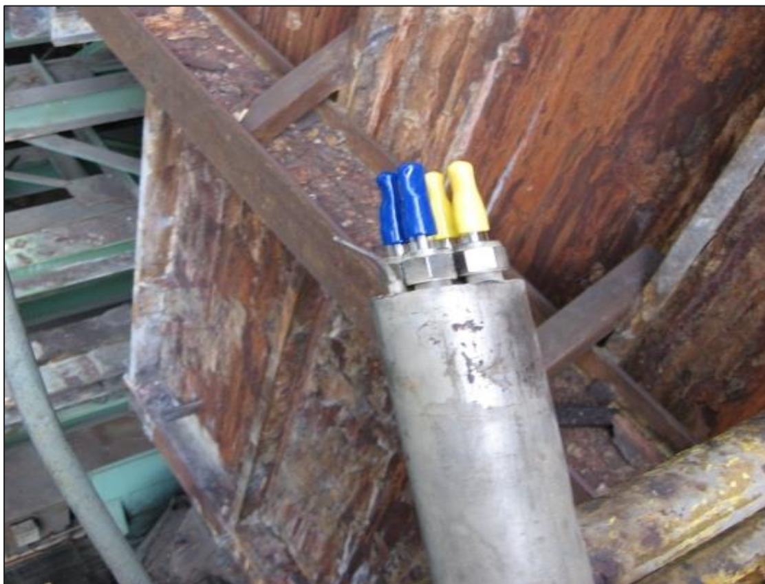
Рисунок I-5: Пробоотборный зонд с установленными торцовыми заглушками
