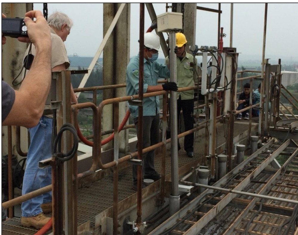
Рисунок I-6: Ввод пробоотборного зонда в газоход
