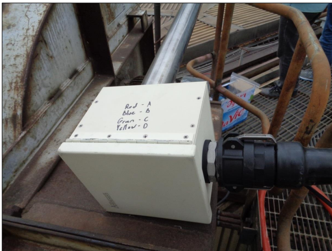
Рисунок I-4: Зажим крепления нагреваемой пробоотборной линии к нагреваемому блоку фильтра
