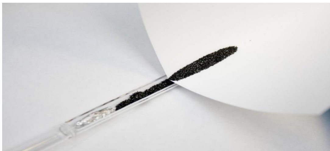
Рисунок II-8: Перенос сорбента в кварцевый дозатор проб
