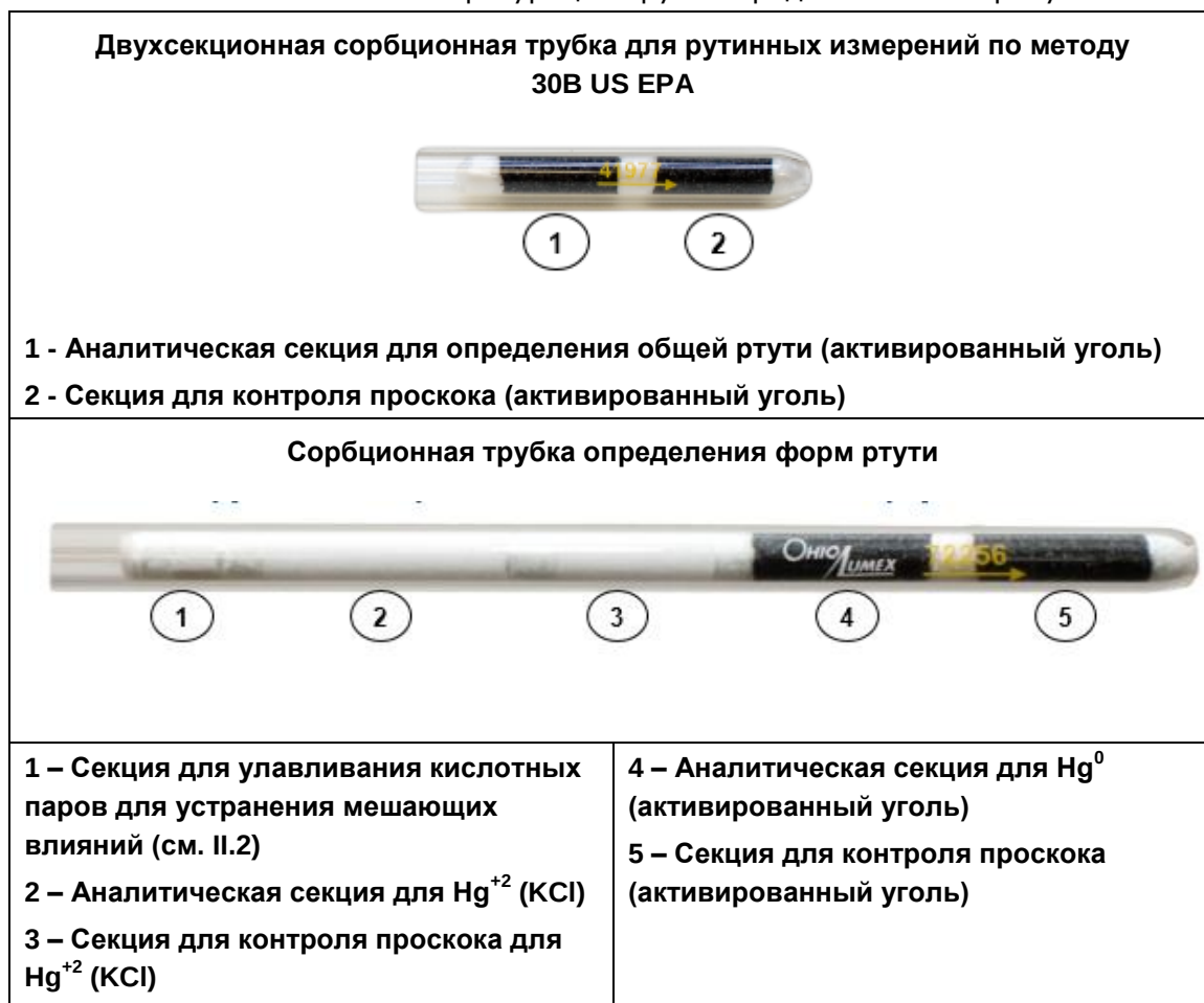
Рисунок II-3 Сорбционные трубки (направление потока газа указано стрелками)
