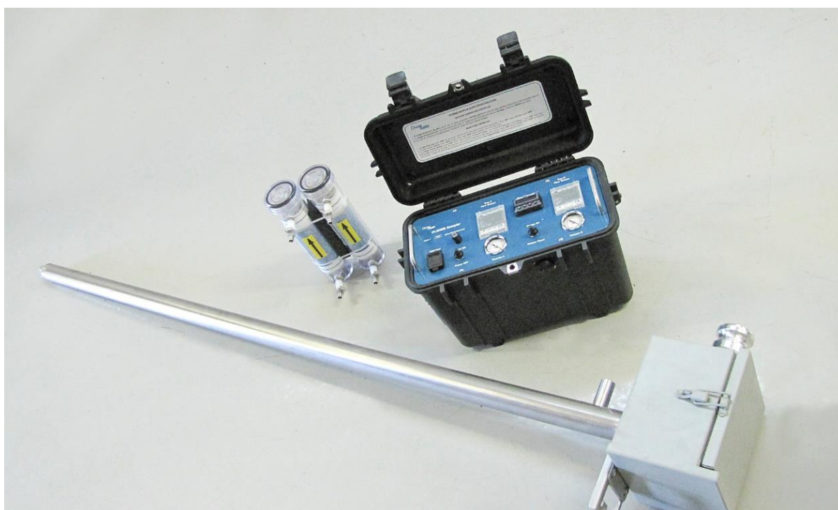
Рисунок I-3: Переносная система отбора проб 30В
