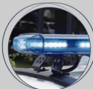
Feux bleus à LED homologués en France par l'UTAC, norme ECE-R65. Fonction patrouille intégrée. (Éclairage bleu de la rampe en mode fixe pour signaler la présence d'une patrouille)
