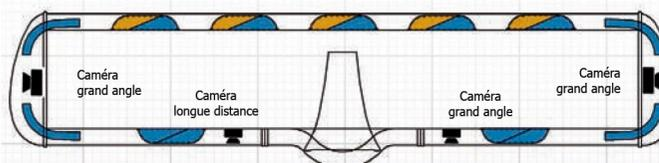
**Modèle présenté :** rampe VEGA avec sirène intégrée, défilement arrière (5 feux bicolores bleu/orange) et option vidéo (4 caméras intégrées).
