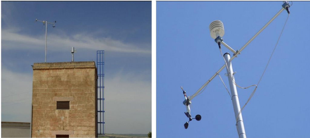
Fig.9 Localizzazione e dettaglio della centralina meteoroclimatica installata in discarica.
