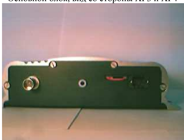
Основной блок, вид со стороны ХР3 и ХР4
