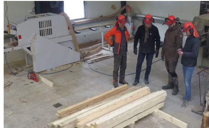
Límtré Vírnet gerir tilraunir með límtré úr fjórum helstu timburtegundum sem ræktaðar eru á Íslandi, talið ofan og niður: rússalerki, alaskaösp, sitkagreni og stafafura.
