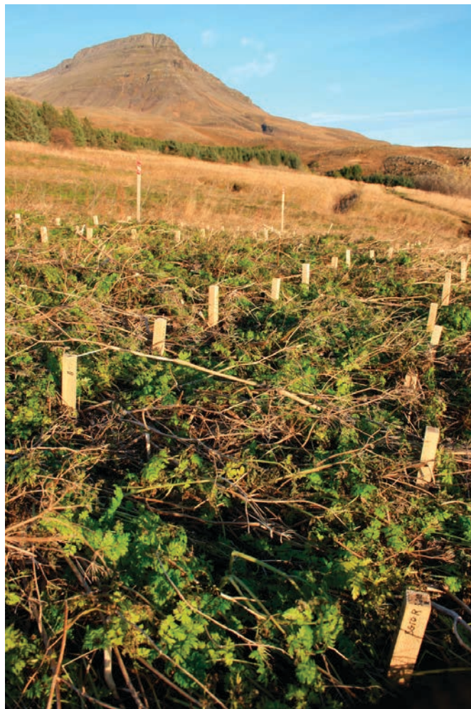
Pinna-tilraun í Esjuhlíðum, rannsókn á endingu ómeðhöndlaðs trjáviðar með snertingu við jörð
