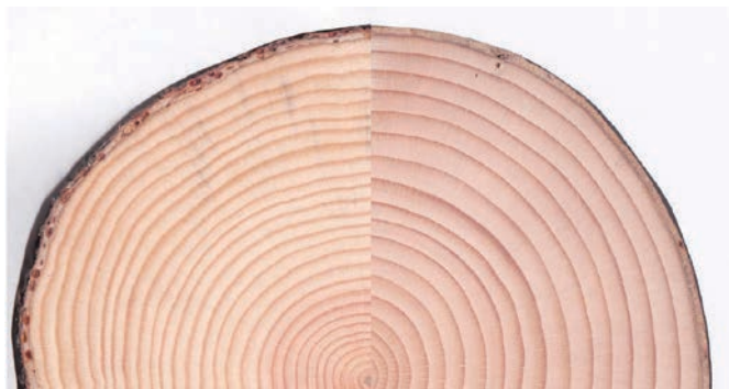
Þversnið sem sýnir misstóra áhringi stafafuru til vinstri og sitkagrenis til hægri. Vorviður ljóslitur en sumarviður dökkleitur. (Sýni SF8A1 0,30 m frá rót og SG4B1 4,5m frá rót).
