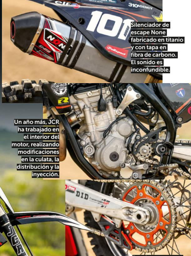
Silenciador de escape None fabricado en titanio y con tapa en fibra de carbono. El sonido es inconfundible.
