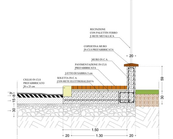
PARTICOLARE COSTRUTTIVO MARCIAPIEDE DI PROGETTO rapp. 1: 20
