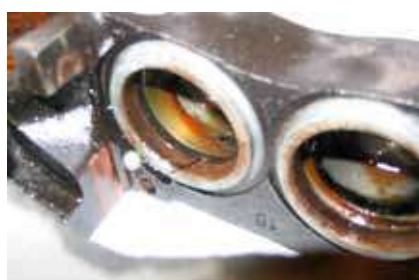
Spid en tætningsring med en nål for at fjerne tætningsringen
