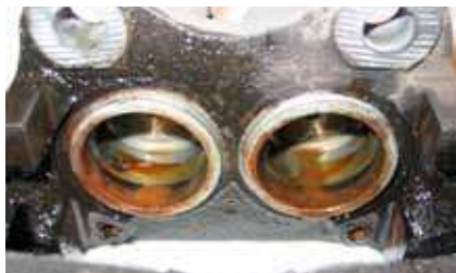
De fjernede stempler viser rustangrebne cylindervægge
