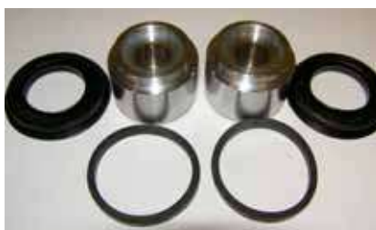
Nye stempler, stempelringe og af-dækninger/støvmanchetter
