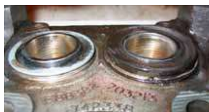
Efter isætning af nye/rensede stempler monteres støvmanchetter
