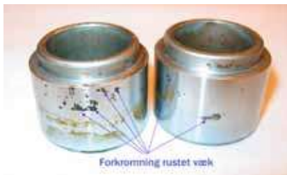
Rustangrebne rengjorte stempler, der bør kasseres
