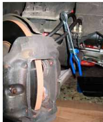
Sammenklem bremseslanger inden demontering af kaliber
