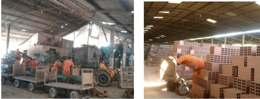
**Figuras 5 e 6.** Processo de fabricação e secagem das peças ao tempo.
