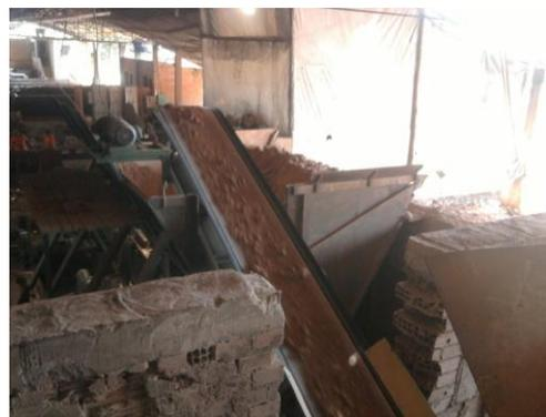
**Figuras 3 e 4.** Área externa e empilhamento da argila extraída. Direcionamento da argila triturada para moldagem dos tijolos.
