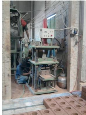
**Figura 9.** Estocagem matéria prima em área coberta e descoberta. **Figura 10.** Máquina onde é colocada a mistura e tijolos já prensados.
