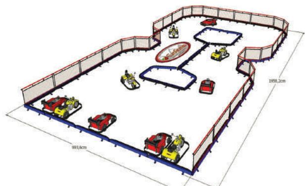
Pavimento consigliato: cemento lucido industriale. In alternativa si può utilizzare un pavimento in asfalto.
