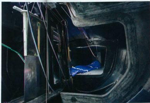
Noir c'est noir. Sous le pont, c'est toute une histoire : quille relevée avec son trimmer, drisses avec leurs télécommandes, mât carbone avec son mast-jack permettent d'ajuster la tension du gréement PBO en continu.
