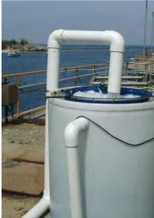
**Figura 9: Foto de un mecanismo de bombeo para realizar muestreos de ictioplancton. Fuente: HDR**
