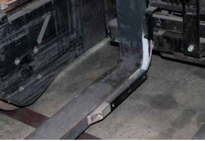
Kleine Maßnahme - große Wirkung: Mit der Kamera an der Gabel und dem Monitor in der Kabine wird das Ein- und Ausfahren auch über die dritte Ebene hinaus zum Kinderspiel.
