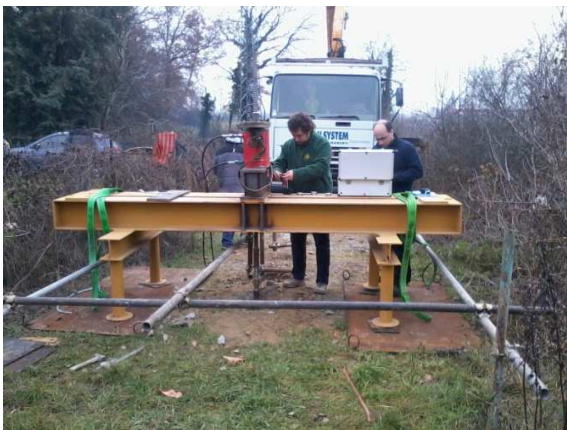
Foto 1 . Dispositivi per l'applicazione e la misura del carico
