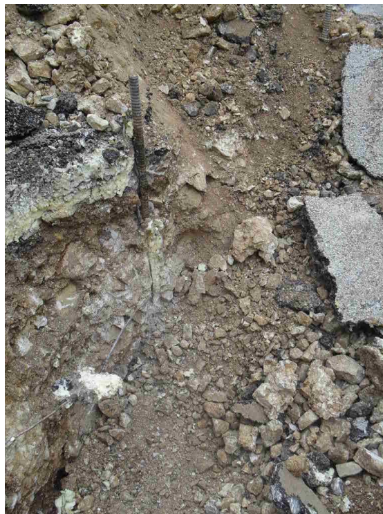
Foto 6,7 . Campo prova 1 : Scavo a fine prova sul minipalo 4R iniettato con resina
