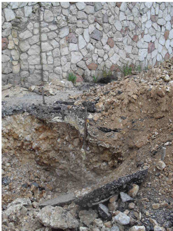
Foto 6,7 . Campo prova 1 : Scavo a fine prova sul minipalo 4R iniettato con resina
