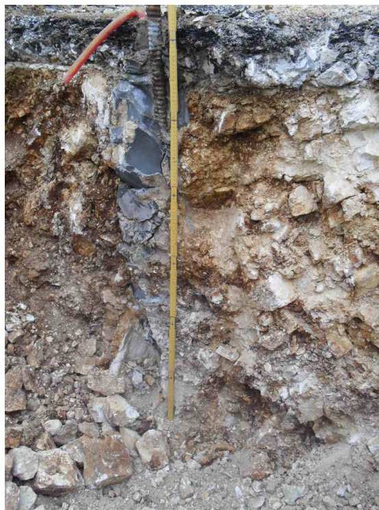
Foto 7,8 . Campo prova 1 : Scavo a fine prova sul minipalo 8B iniettato con boiaccia
