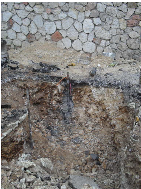
Foto 7,8 . Campo prova 1 : Scavo a fine prova sul minipalo 8B iniettato con boiaccia
