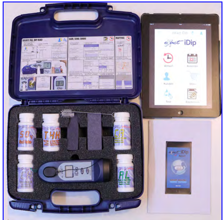
Abb. 1. Start-Grundkoffer eXact iDip für Brauwasseranalysen ( Info ). Zusätzlich wird ein Smartphone oder Tablett benötigt (oben rechts).
