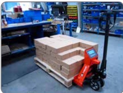
Ääni- tai valomerkki, kun haluttu paino saavutettu.
