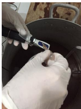
Figura 22. Medição da densidade do mosto pré-fervura.
