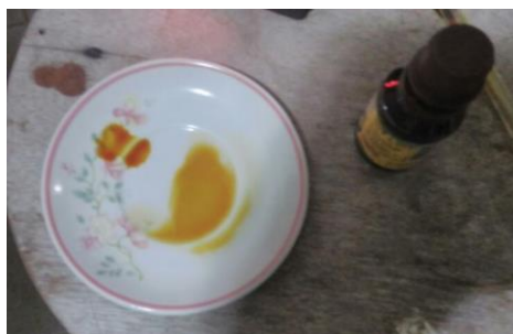
Figura 16. Teste do iodo realizado no início do cozimento, comprovando a alta existência de amido presente no mosto.
