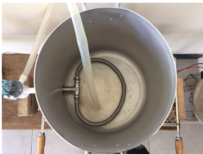
Figura 3. Bazooka e sistema de recirculação utilizados no processo.
