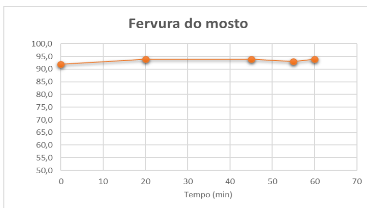
Figura 23. Curva de temperatura de fervura.
