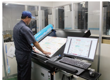
A輪4ライン分のジョブを1台の「コレクトアイシス」で検査
