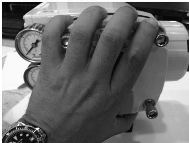
Figura 26 – Remoção da tampa frontal
