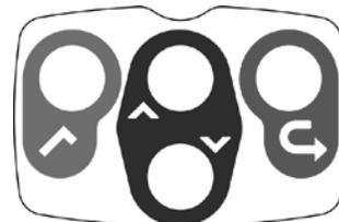
Figura 23 – Etiqueta para instalação do posicionador Chronos de ponta-cabeça (vista quando o atuador da válvula e o posicionador ainda estão na posição normal)
