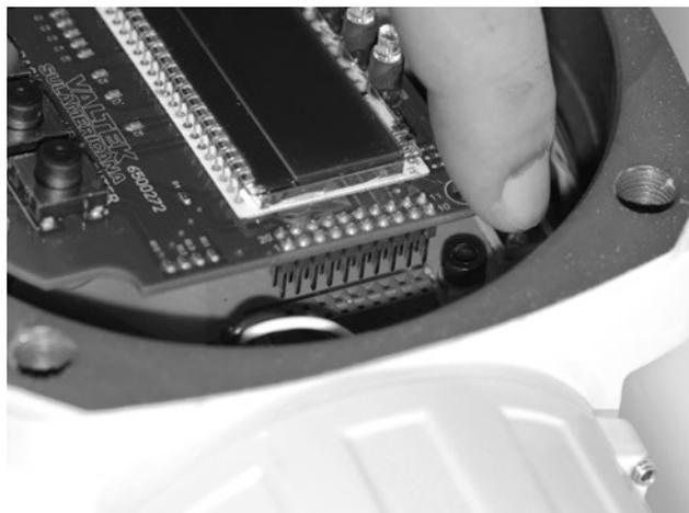
Figura 27 – Remoção da placa da interface com o usuário
