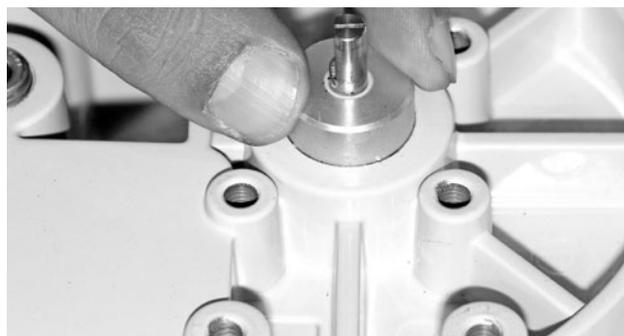
Figura 29 – Remoção do conjunto do potenciômetro
