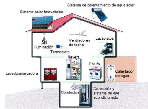
Figura II-3 Equipos y accesorios de una vivienda.
