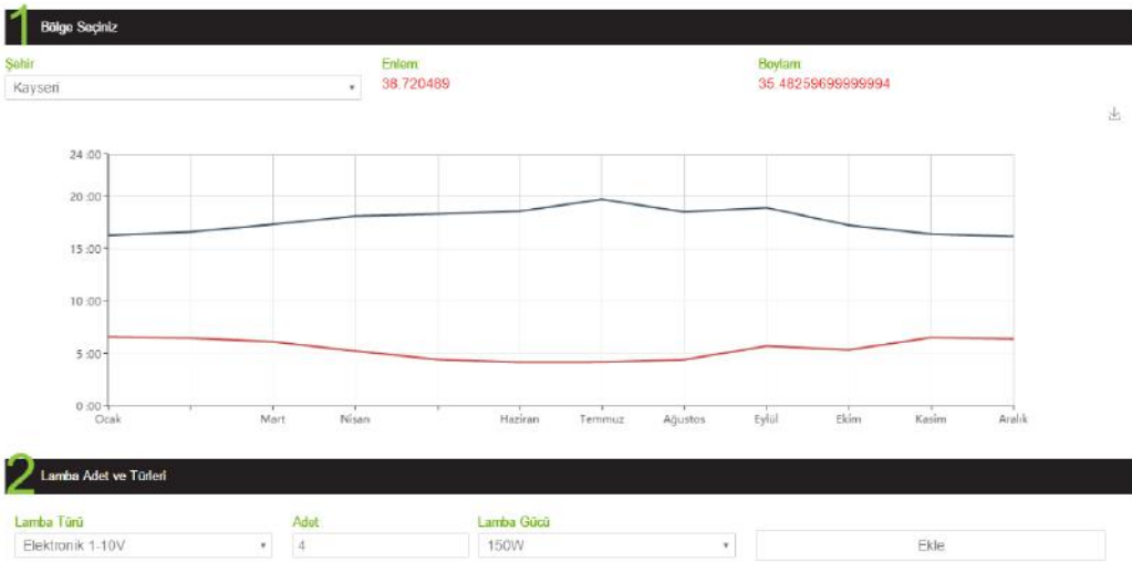
Şekil 4. 4 adet 150W PWM dimli sodyum buharlı armatür için yapılacak 1 yıllık enerji tasarrufu
