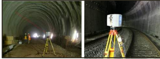
Şekil 3. 7 Yüksek çözünürlüklü YLT ve tünellerin taramaları [32], [61]
