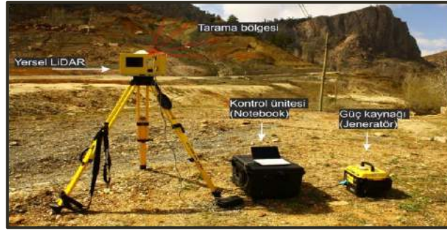
Şekil 3. 6 Yersel lazer tarayıcı (YLT) ve bileşenleri [56], [57]
