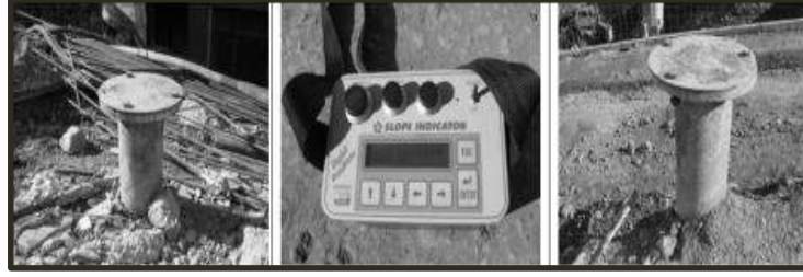
Şekil 3. 5 İnklinometre kuyusu ve kayıt ünitesi [53]
