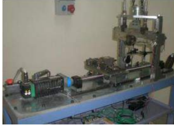
Şekil 5 Deneylerde kullanılan bilgisayar kontrollü ani duruşlu ortogonal talaş kaldıran cihaz
