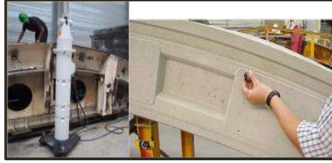
Şekil 3. 11 Segment kalıbı ve segmentlerin ölçümü [39]
