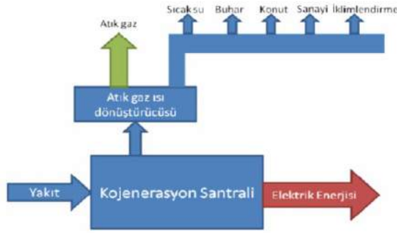
Şekil 1. Basit Kojenerasyon Sistemdeki Isı-Enerji Dağılımı
