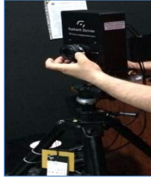
Şekil 8. LED dizilimlerinin gonyometrede ölçümü için kamera ayarlarının yapıp ölçüme hazır hale getirilmesi
