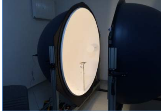
Şekil 7. LED dizilimlerinin fotometrik ölçümlerini gerçekleştirdiğimiz küre görünümü
