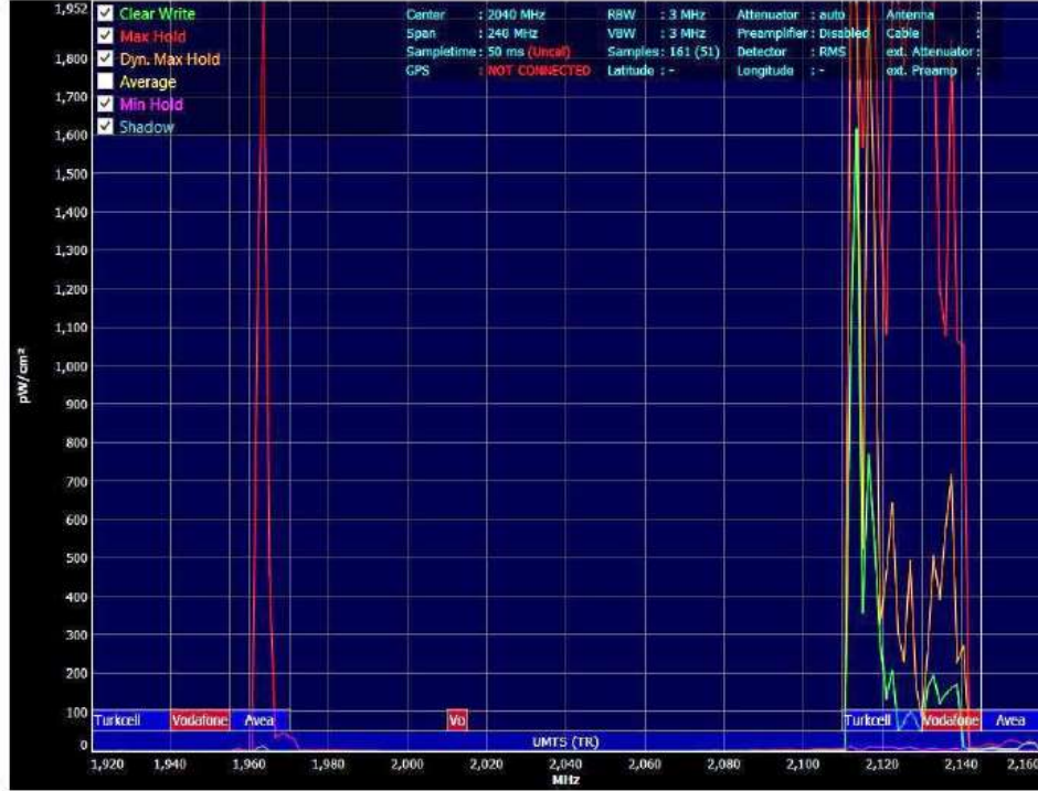
Şekil 4. Aaronia Spectran HF-60105 V4 Taşınabilir Spektrum Analizörü ile UMTS 2100 MHz frekansında alınan eşdeğer düzlem dalga güç yoğunluğu spektrumu
