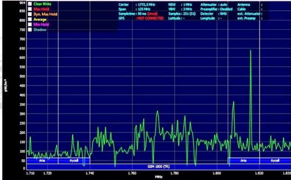
Şekil 3. Aaronia Spectran HF-60105 V4 Taşınabilir Spektrum Analizörü ile GSM1800 MHz frekansında alınan eşdeğer düzlem dalga güç yoğunluğu spektrumu
