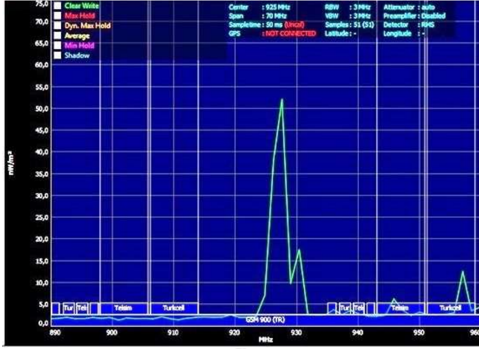
Şekil 2. Aaronia Spectran HF-60105 V4 Taşınabilir Spektrum Analizörü ile GSM900 MHz frekansında alınan eşdeğer düzlem dalga güç yoğunluğu spektrumu
