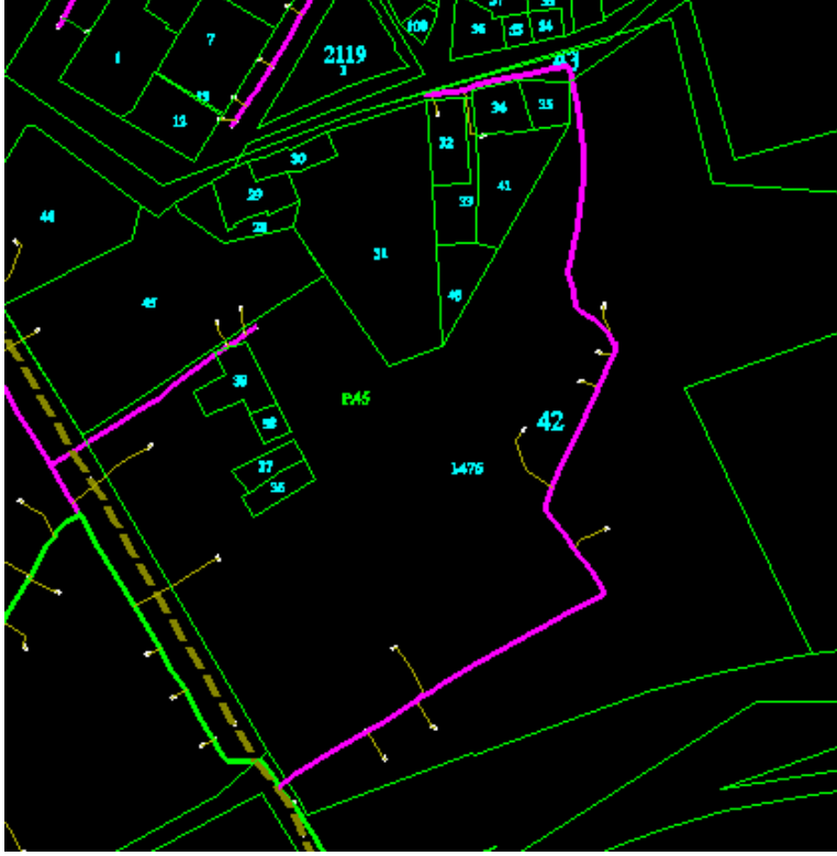
Şekil 7. Parsel içerisindeki doğal gaz hattı
