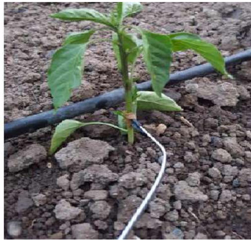
Şekil 2.2. Bitki Nem Sensörünün Bitki Gövdesine Yerleştirilmesi
