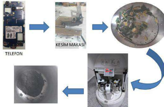
Şekil 3. Cep telefonu kartları için numune hazırlama süreci
