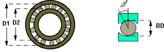
Şekil 3. Bilyeli ve silindirik makaralı rulmanlarda arıza frekansı hesabı için boyutlar [13]. Aşağıdaki ifadelerde,
