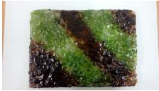
Сурет 2 – Зертхана жағдайында жасалған шыны плиткасы
