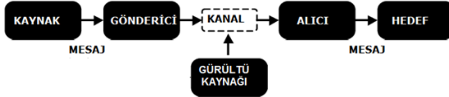
Şekil 2: Shannon'ın genel iletişim sistemi modelinden uyarlanmıştır (1948).
