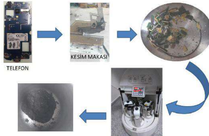
Şekil 3. Cep telefonu kartları için numune hazırlama süreci
