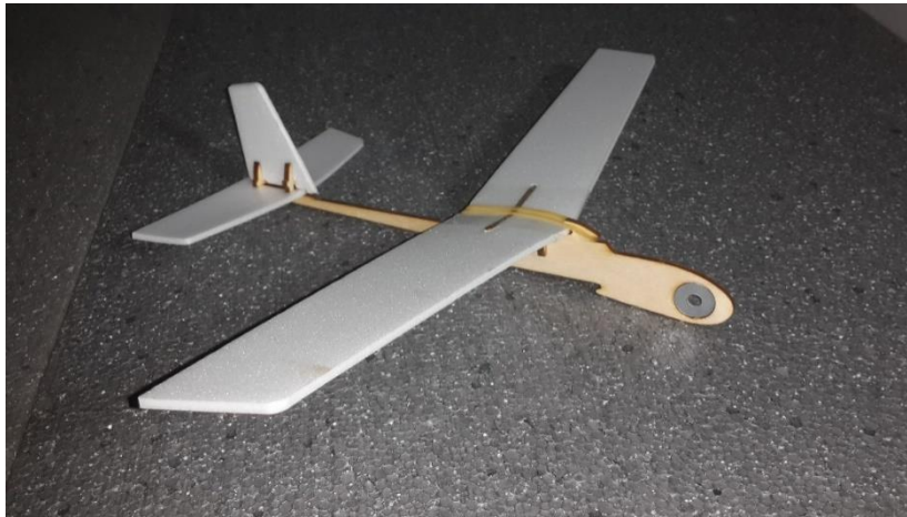
Figür – 2 Mini planör ( Yaklaşık ağırlığı 6 gr )
