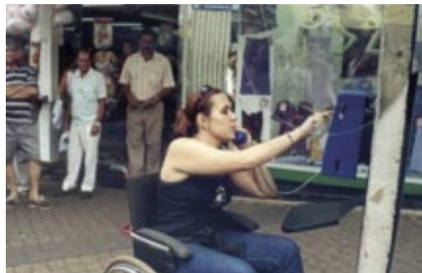
Figura 3: Fotografia mostrando telefone público instalado em altura que atende tanto a pessoa sentada quanto à pessoa em pé, concebido a partir do desenho universal. Fonte: Brasil, 2006a.
