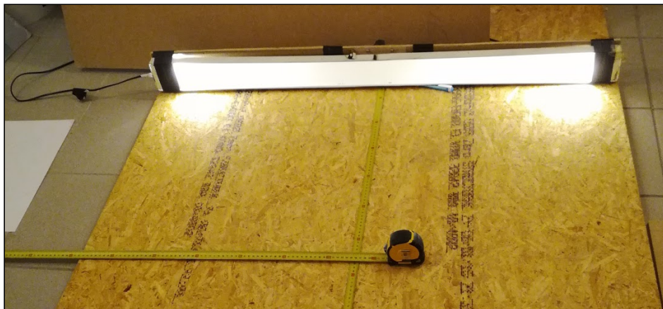
Figure 21 - Photographie de l'expérience 'diagramme polaire'
