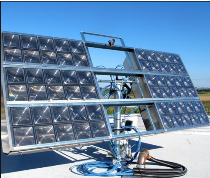
Figure 1 - Panneau aux lentilles de Fresnel Figure 2 - lumière transmise par fibre optique
